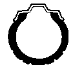
Pression trop haute
