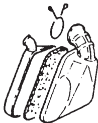
TAV.9 Serbatoio carburante-Serbatoio olio - Fuel tank-Oil tank - Reservoir carburant-Reservoir d'huile - Benzintank-Öltank - Tanque carburante-Deposito aceite
